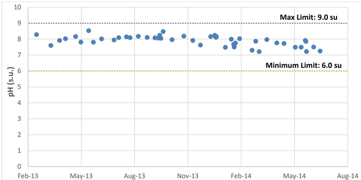
**Figure 16. WTP Effluent pH**
