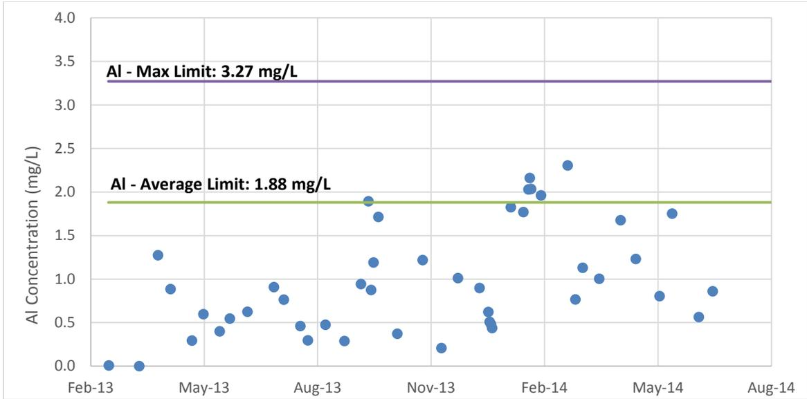
**Figure 13. WTP Effluent Aluminum**
