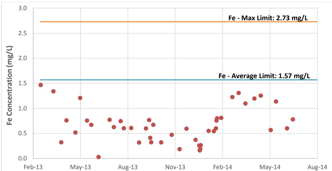
**Figure 14. WTP Effluent Iron**
