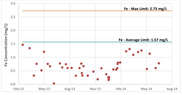
**Figure 14. WTP Effluent Iron**
