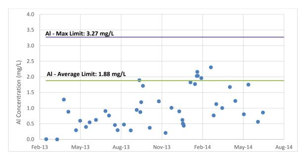
Figure 13. WTP Effluent Aluminum
